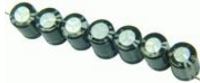
Goldcap-Module mit 7 Goldcaps (7 x 1F in Serie, also 140000 F - 17,5 V)
